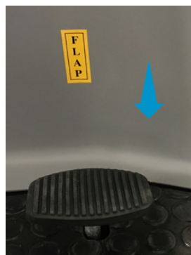
Bedien de vuilflap onder het rijden zo nu en dan op- en neer. Grotere stukken vuil worden dan doorgelaten naar de borstel zodat deze ook opgeveegd kunnen worden.
