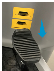
Laat de zijborstels zakken en zet deze en de afzuiging aan. De afzuiging zorgt ervoor dat het stof wordt afgezogen.
