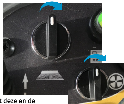
Laat de zijborstels zakken en zet deze en de afzuiging aan. De afzuiging zorgt ervoor dat het stof wordt afgezogen.
