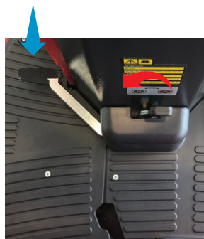
Bedien de ('hand')rem door het LH pedaal te activeren en de hendel over te halen
