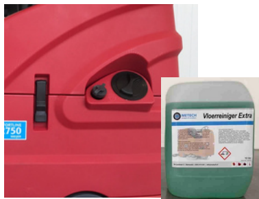
Vul de schoon-watertank met water en Metech vloerreiniger
