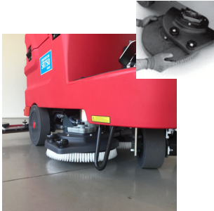
Controleer en reinig de borstels
