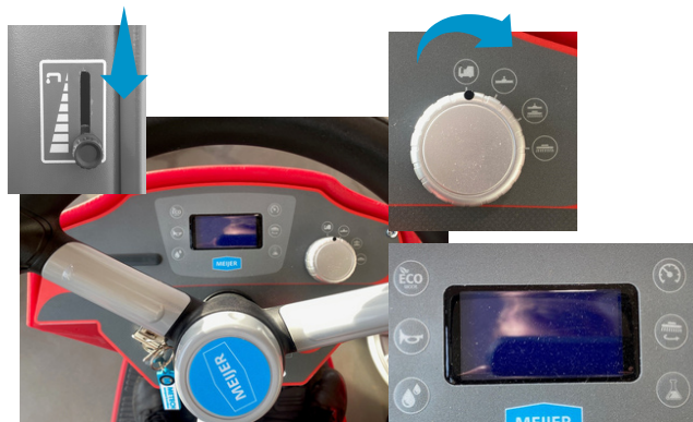
Kies de juiste functie en zet de waterkraan open
