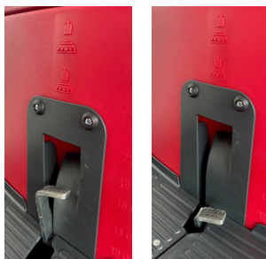
Activeer de hendel voor zwaardere borsteldruk. Dit is voor incidenteel gebruik
