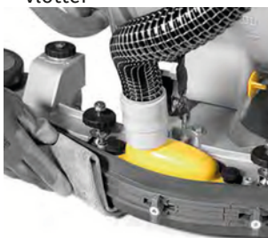
3. Controleer de conditie van het filter in de vlotter
