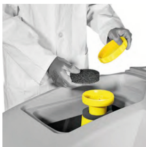
3. Controleer de conditie van het filter in de vlotter
