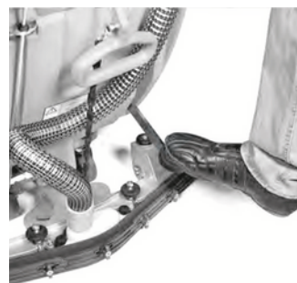
3. Laat het schrobdek zakken
