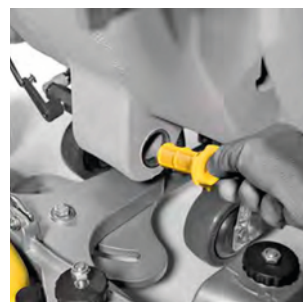
6. Reinig het schoonwater-filter
